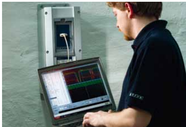
با اتصال کامپیوتر توسط یک کابل RS232 به VFX امکان استفاده از نرم افزار Emosoft جهت تنظیمات و بررسی خطاها وجود دارد
