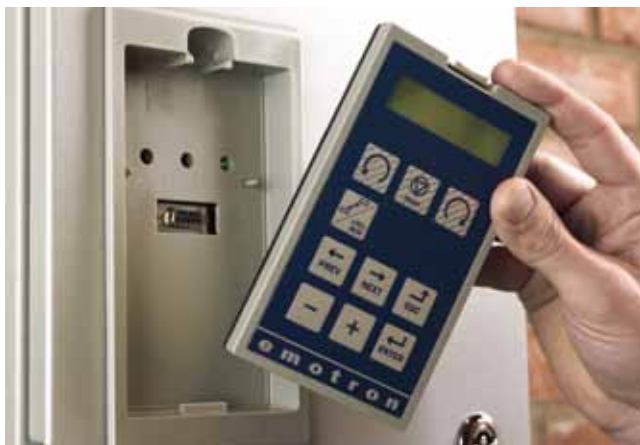
کنترل پانل اینورترهای Emotron قابلیت کپی و انتقال پارامترها را از یک اینورتر به اینورترهای دیگر دارد.
