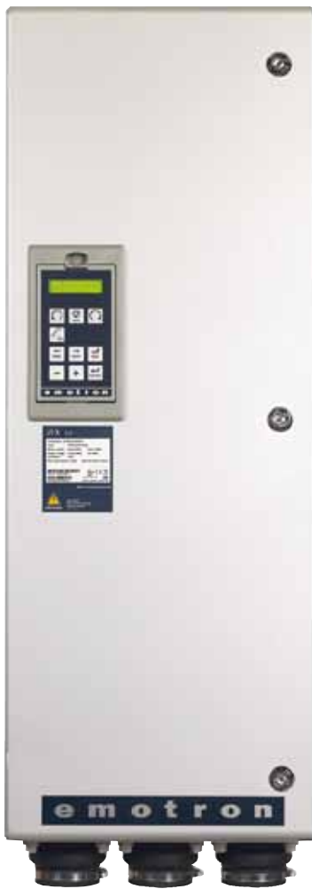
اینورترهای ۲.۵ تا ۲۵۰ آمپر VFX با درجه حفاظت IP54 امکان نصب را در خارج تابلو و در نزدیک ترین محل به موتور را دارند.
